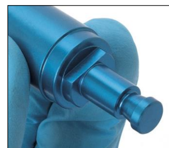
Protipól Hudsonovy spojky u perforačního vrtáku musí být zasunut v jedné rovině se zářezem druhého dílu.
