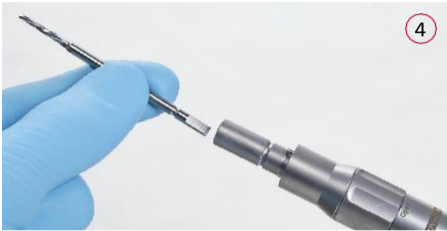
Vložte kraniální frézu do upínacího přípravku kraniotomu a mírným pootočením stabilizujte její uložení.
